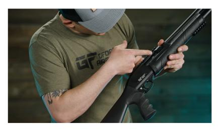
STEP 2: UNSCREW MAGAZINE CAP, PRESS THE ACTION RELEASE BUTTON AND PULL THE FOREND REARWARRD. THEN, PUSH FOREND FORWARD FIRMLY TO HELP SEPARATE THE BARREL FROM THE RECEIVER.
